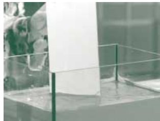
Teststücke, die mit herkömmlicher Fassadenfarbe gestrichen wurden, bleiben im Schlammbad nicht unbefleckt. Rechts ein Versuch mit Lotus-Effekt-Farbe.
