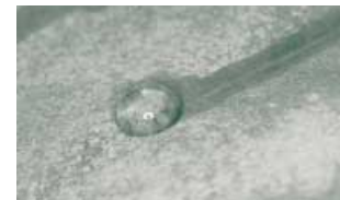
Durch die spezielle Lotus-Oberfläche zieht sich Wasser durch seine Oberflächenspannung fast bis zur Kugel zusammen. Aufgenommener Schmutz schwimmt auf seiner Oberfläche.
